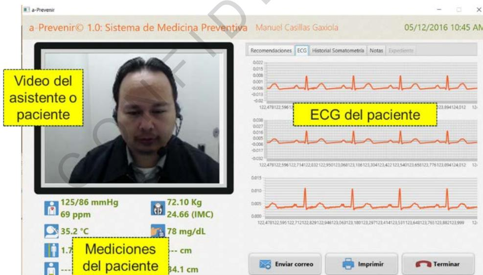
Figura 8. Pantalla del módulo de videoconferencia del sistema a-Prevenir® habilitado con un electrocardiógrafo del lado del médico.
